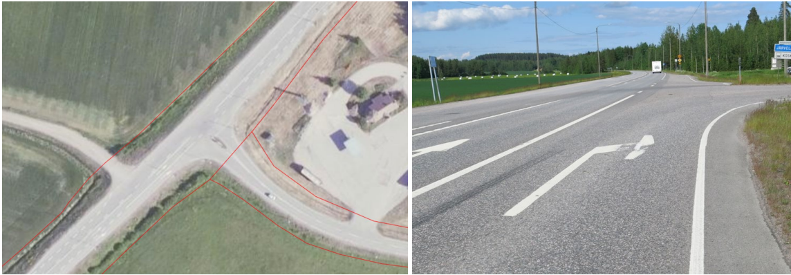
Kuva 5.1 Maantie on kanavoitu Hähkäniementien puoleiselta osuudelta.
