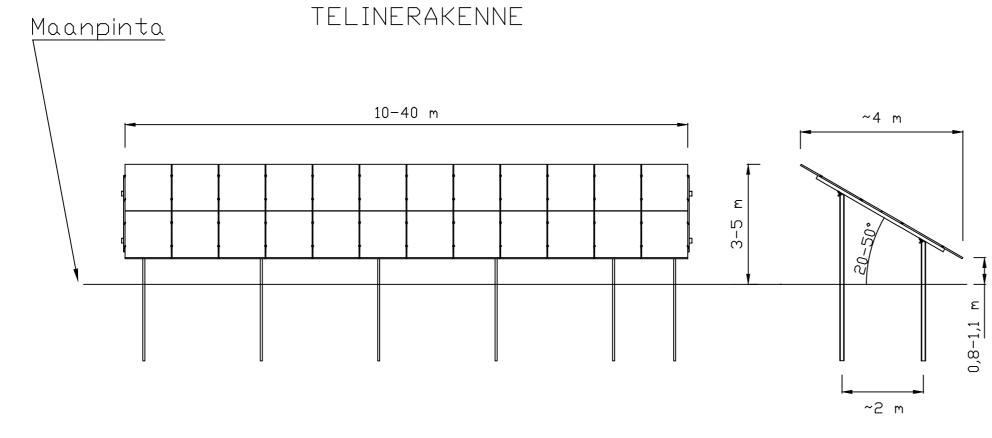
Aurinkopaneeli telineet perustetaan ruuvipaalu-, ns. c-profiilipalkkitai vaihtoehtoisesti pinta-asennuksena betonipainoperustuksille.
